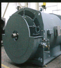
Napęd: pompy odśrodkowe. Silnik indukcyjny przeciwwybuchowy HV. Moc: 2.500kW 2 biegunowy 6.000V Projekt: Rafineria Shazand Arak
