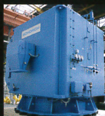
Napęd: pompy wody chłodzącej w elektrowni. Pionowy silnik indukcyjny HV. Moc: 3,120 kW 20 biegunowy 10.000 V. Projekt: Blok energetyczny, Niemcy
